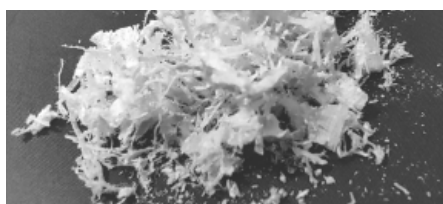
Obtención de las Fibras de Colágeno a partir de la molienda de Parche de Colágeno.
